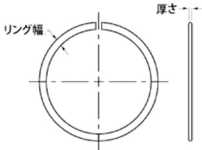
単巻ラミナルシールリング YH または YS は、広範囲な用途に使用されています。これらのリングは、一般的に、グリースや潤滑剤をせき止め、水やその他の汚染液がアッセムブリの重要領域に入り込むのを防ぐことで、ベアリングシステムを保護するために使用されます。交互配置(スタagger)シリーズ YHK と YSK は、(ラビリンスシールの強化により) 密閉効率をさらに改善します。これらは、作動温度が高いため潤滑用グリースが液化する場所や、大量の汚染液(冷却水など)からの保護が必要な場所によく選択されます。
