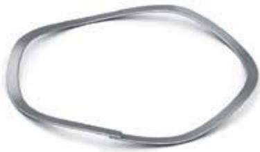
スモーリー社の Circular-Grain® ベ어링プリロード ウェーブ スプリングは、遊びを無くしてベ어링ノイズを最小限にします。一定の軽度または中度の圧力をかけることで、ボールベ어링とベ어링の内部および外部レース間の遊びを無くします。プリロードをかけることで、振動(振動荷重)によるベ어링の損傷および反復的または非反復的な逃げによる磨耗の可能性を減少させます。
