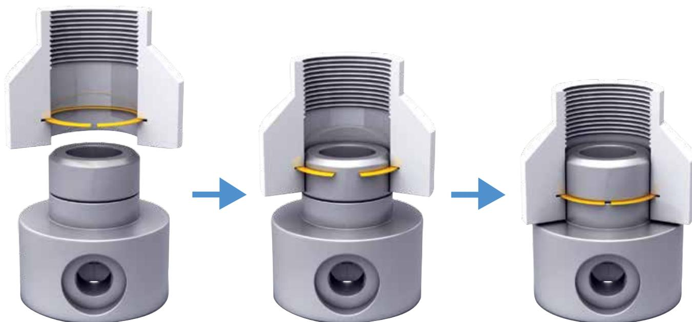
下図に示すニューマチックフィッティング（空気圧用管継手）用途では、取り外しノッチまたはオフセットを持たない 2 巻リテーニングリングは、ID/OD ロックを作り、ナットの 360° 回転を可能にします。
