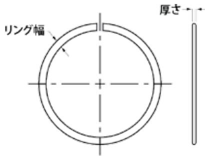
単巻ラミナルシールリング QH または QS は、広範囲な用途に使用されています。これらのリングは、一般的に、グリースや潤滑剤をせき止め、水やその他の汚染液がアセンブリの重要領域に入り込むのを防ぐことで、ベアリングシステムを保護するために使用されます。交互配置（スタガード）シリーズ QHK と QSK は、（ラビリンスシールの強化により）密閉効率をさらに改善します。これらは、作動温度が高いため潤滑用グリースが液化する場所や、大量の汚染液（冷却水など）からの保護が必要な場所によく選択されます。
