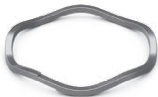
ネステッド ウェーブ スプリングは、一本の連続した平角線を、平行にプリスタックしています。高い荷重を得るのに、個別のスプリングをスタックする必要はなくなりました。ネステッド スプリングは、巻数に比例してばね定数が増加していきます。これは膨大な力を発揮することができながらも、円形粒子ウェーブ スプリングの精度を保ちます。大きな、しかし正確な力が必要な多数の用途では、ネステッド ウェーブ スプリングがベルビルスプリングに置き換わります。
