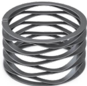
平らなシム エンドの Crest-to-Crest® ウェーブ スプリングもあります。プレーン エンドのウェーブ ポイントによる接触点と比較して、シム エンドは 360° の接触面を提供します。荷重のかかったシム エンドは、隣接するコンポーネントにスプリングの力を均一に分布させます。この機能は、平面用のダブル ディスク グラインド スプリングのコンセプトを当てはめたのと同様です。シム エンドは、フラットな受け面をさまざまな方法でアセンブリに付着できるので、スプリングをはめ合い部品に取り付ける場合にも使用されます。
