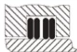
Série YSD Série QSD Externo - serviço médio/pesado 1 conjunto = 2 anéis individuais (os anéis rotacionam apenas com o eixo)
