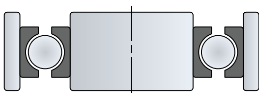
Rolamento sem uma pré-carga: a folga entre os componentes pode causar vibrações e desgaste.
