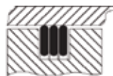
Série YH Série QH Interno - serviço leve 1 conjunto = 3 anéis individuais (os anéis rotacionam apenas com o orifício)
